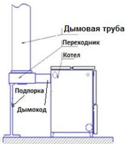
Рисунок 8. Схема установки котла (вид сверху)
